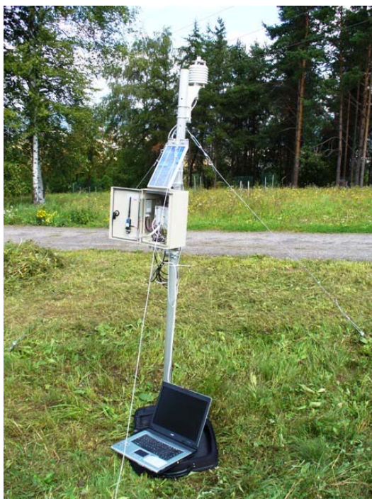
Obrázok 1: Digitálna meteorologická stanica
